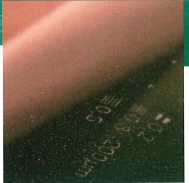
Ein Kernthema auf der Jahrestagung war druckbare anorganische Elektronik. Hier dargestellt: mittels Tintenstrahldruck erzeugte Strukturen aus Zinkoxid-Nanopartikeln auf PET-Folie. Foto: Fraunhofer IISB
